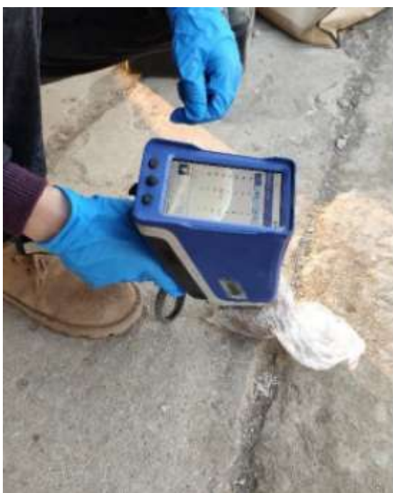
现场 XRF 快速检测
