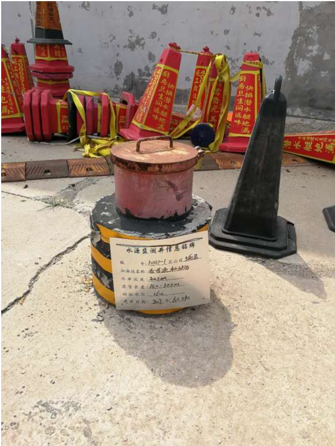
地下水监测井
