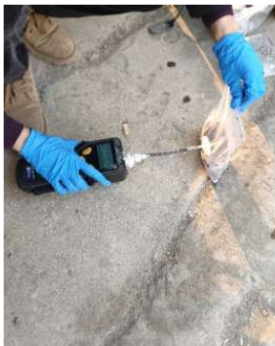
现场 PID 快速检测
