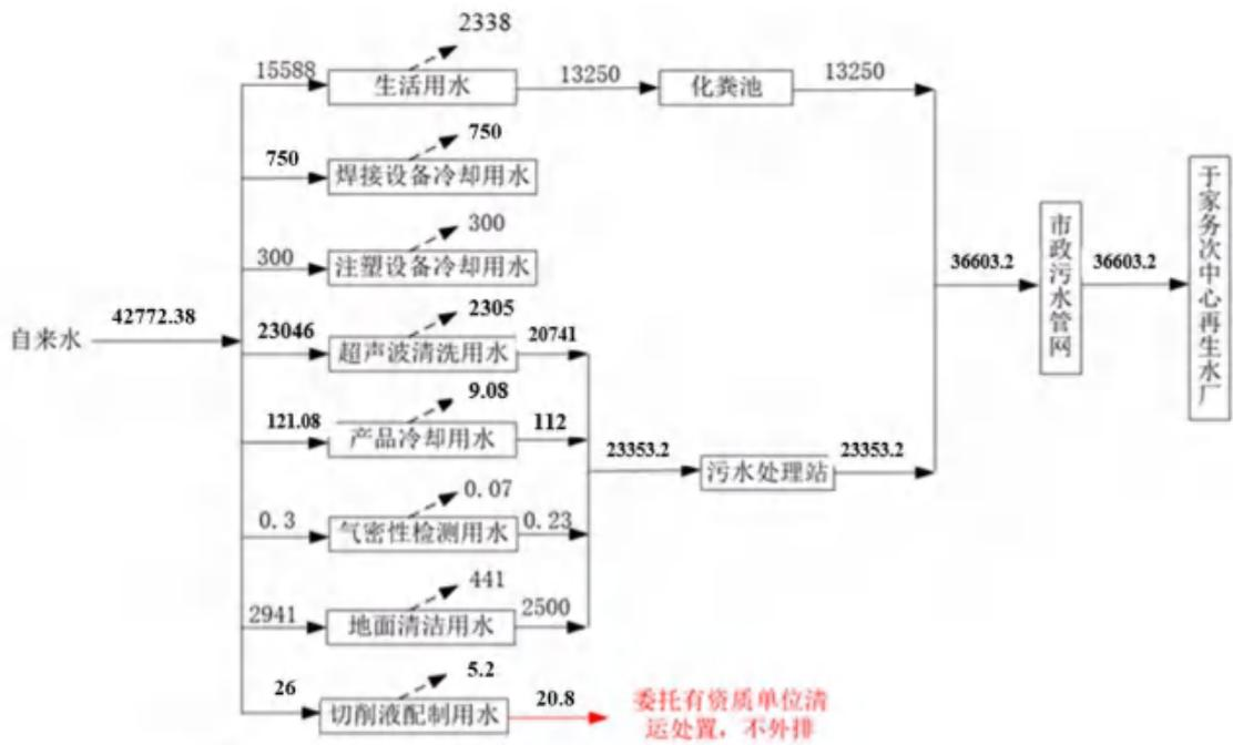
图 2-4 本项目投产后全厂水平衡图 单位： m<sup>3</sup>/a
