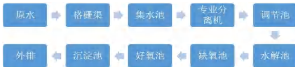
图 2.3-1 现有工程生产废水处理工艺流程图
