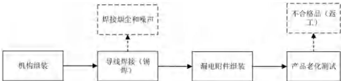
图 2-6 小型断路器附件产品组装工艺流程及产污环节图
