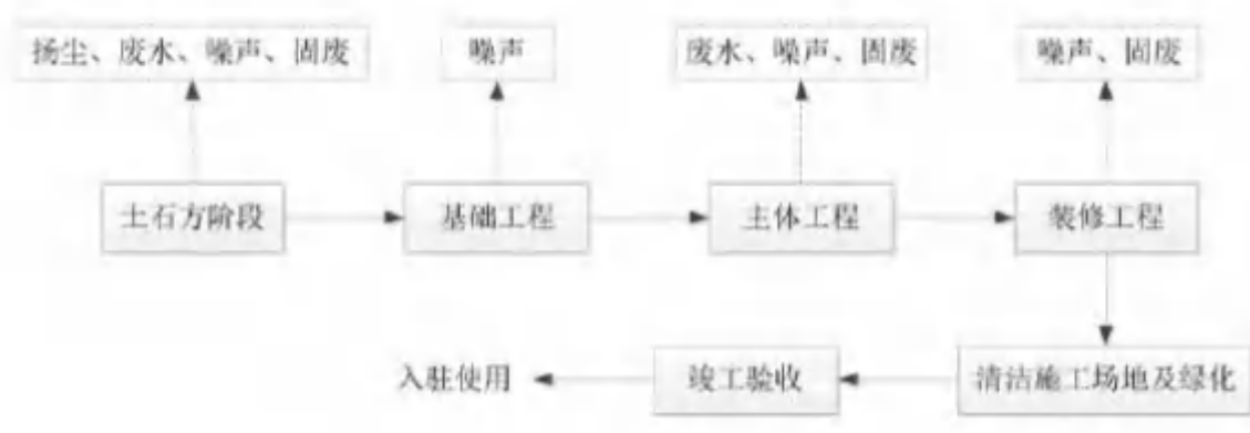
图 2.2-1 施工期工艺流程及产排污环节图
