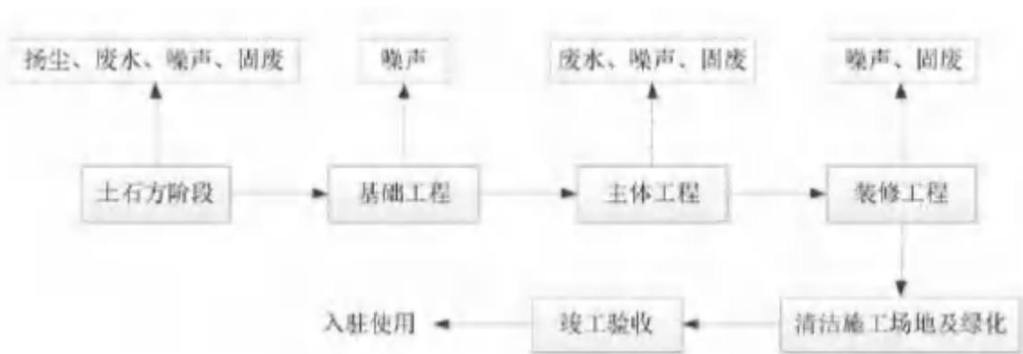
图 2.2-1 施工期工艺流程及产排污环节图
